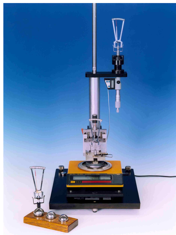
Bild 4.1: Messgeräte zur Prüfung von Impressionstonometern. Links: Mechanische Balkenwaage zur Bestimmung der Tonometermassen sowie Mikrometerschraube zur Messung des Stempelhubs des Tonometers. Rechts: Elektrische Waage zur Bestimmung der Tonometermassen sowie Mikrometerschraube zur Messung des Stempelhubs des Tonometers, davor: Prüfkugeln zur Kontrolle der Nullpunktanzeige.
