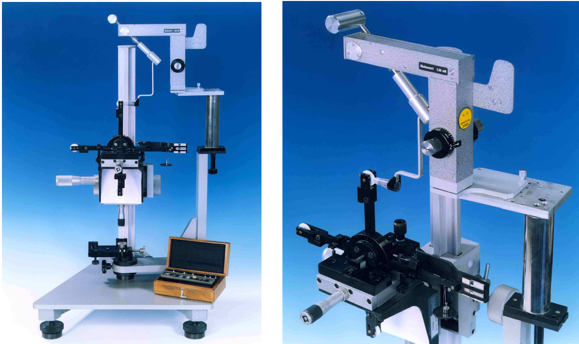
Bild 4.3: Kreuzbalkenwaage zur Prüfung von Applanationstonometern; links: Gesamtbild mit Tonometer, rechts: Detailbild mit Tonometer
